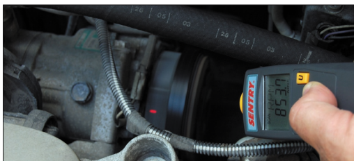
Fot. 3 Pomiar prędkości obrotowej tachometrem ST723
