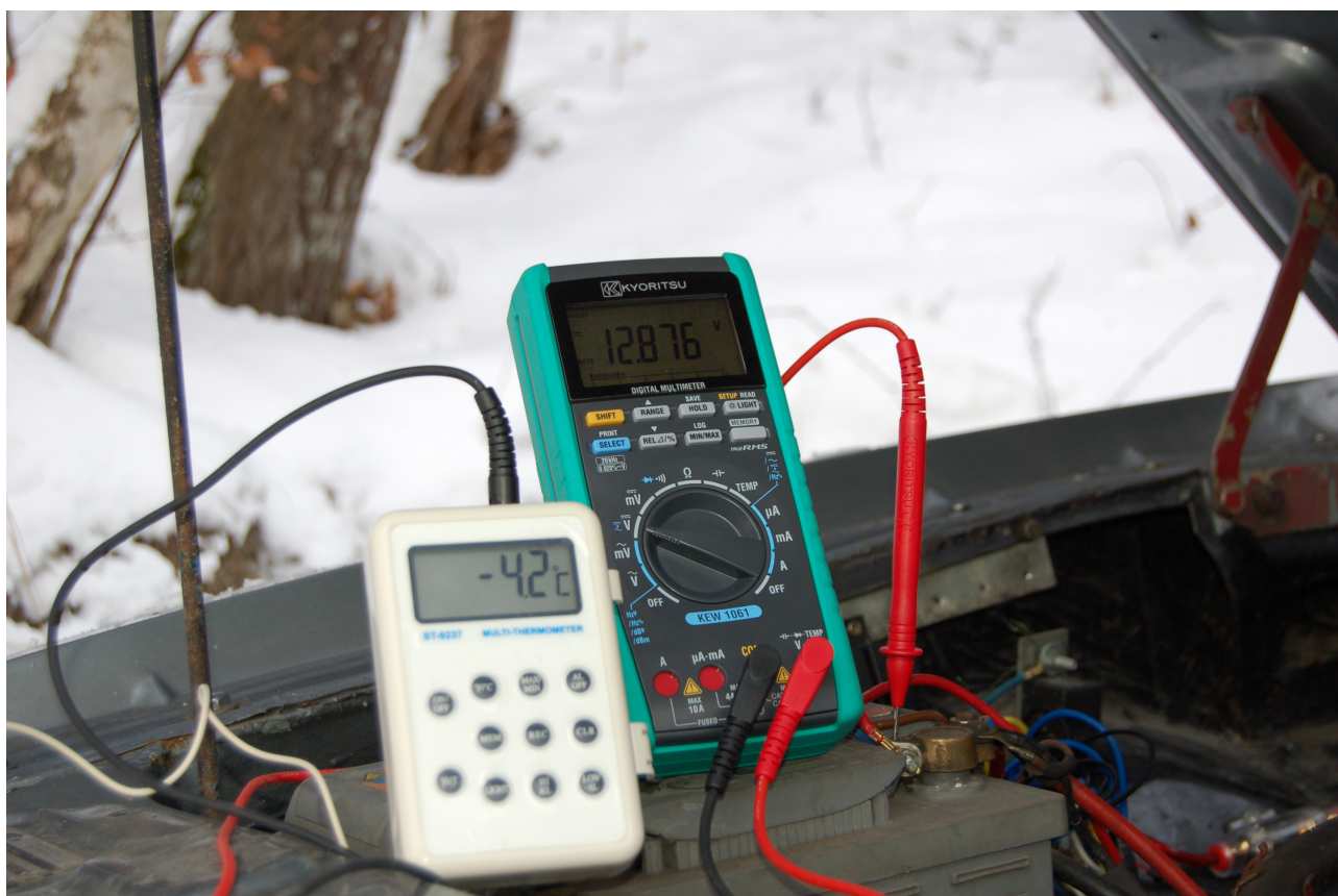
Fot.2 Pomiar napięcia akumulatora miernikiem KEW1062 przy ujemnej temperaturze otoczenia.
