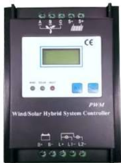
Kontroler hybrydowy VAWT [532002]
