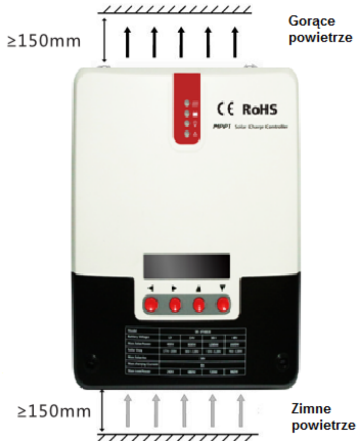
Rys 5. Montaż i rozpraszanie ciepła
