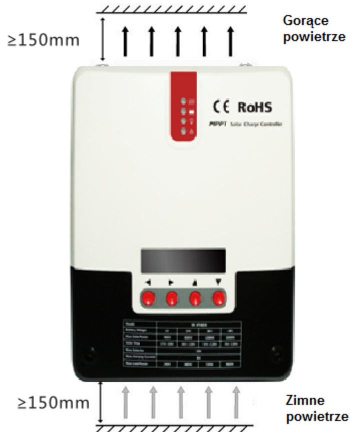
Rys 5. Montaż i rozpraszanie ciepła
