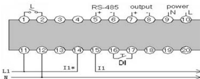
PRO EX L51 (Single) Wiring Diagram
