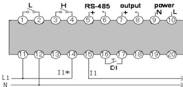
PRO EX P51 (Single) Wiring Diagram
