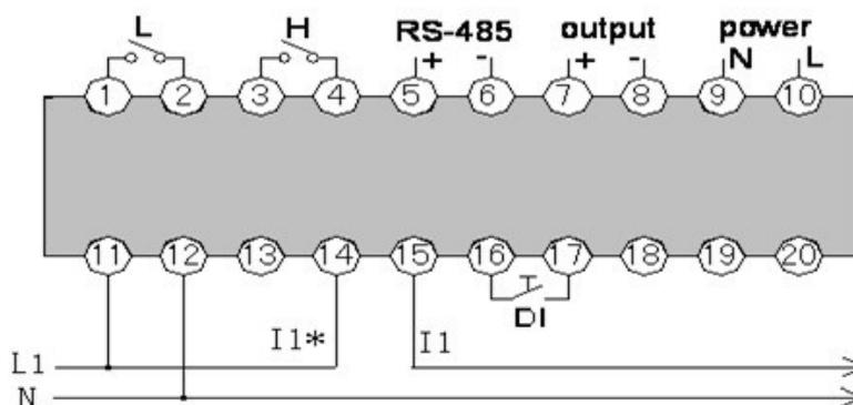
PRO EX P51 (Single) Wiring Diagram
