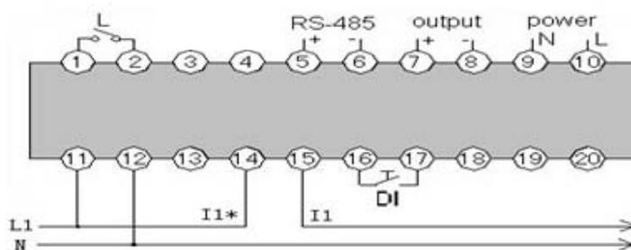
PRO EX L51 (Single) Wiring Diagram
