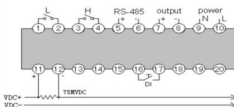
PRO EX DI51 Wiring Diagram
