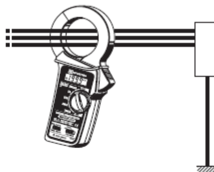
Obwód trójfazowy 3-przewodowy (w obwodzie 4-przewodowym z przewodem neutralnym cęgi założyć na wszystkie 4 przewody)
