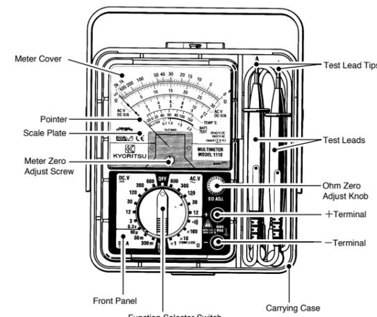
KYORITSU MULTIMETER MODEL 1110
