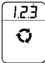
Poprawna kolejność faz Rys.45
